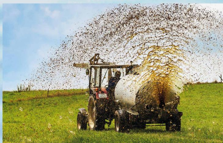
Die Ausbringung von Gülle mit nach oben strahlendem Prallteller ist nicht mehr zulässig. Die Übergangsfrist der entsprechenden Verbotregelung endete 2015.
